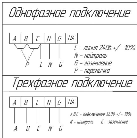
Рис. 4. Схемы подключения электрического котла к электросети.
